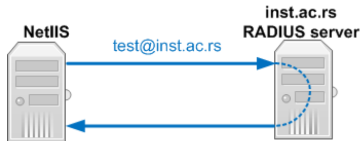
Slika 4: Formiranje EAP tunela direktno između klijenta i RADIUS servera
